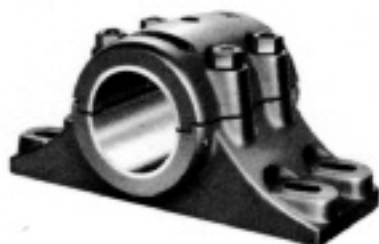
Chumacera Bipartidas tipo MG con guías maquinadas en la base para relevar la presión lateral 4 tornillos de apriete, se suministran en babbitt o en bronce
